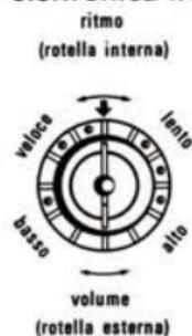
Le rotelle di regolazione del ritmo tonale e del volume si trovano sulla parte destra dell'apparecchio. Richiedete una chiamata e, mentre la soneria squilla, senza sollevare il ricevitore, procedete alla regolazione.
