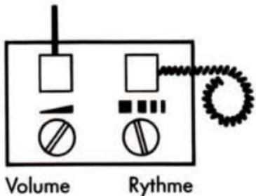
Le signal d'appel peut être réglé à l'aide des deux boutons placés sous l'appareil.
