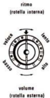
Il volume e il ritmo della soneria elettronica sono regolabili. Le relative rotelle di regolazione si trovano sotto l'apparecchio.
