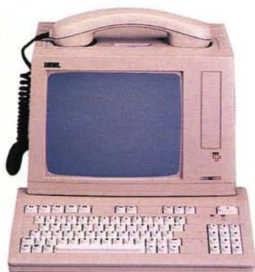
**VIDEOTEX MultiTel.** VIDEOTEX-Gerät mit eingebautem Telefon. Für Datenaustausch mit VIDEOTEX-Stationen im In- und Ausland sowie für normalen Sprechverkehr. Schwarzweiss-Bildschirm 9". Lautsprecher zur Überwachung des Verbindungsaufbaus, verschiedene Funktionstasten, Register für 8 VIDEOTEX-Dienste und 150 Telefon-Nummern. Integriert: VIDEOTEX-Modem für asynchrone Übertragung von 75/1200 Bits pro Sekunde und Decoder für die Darstellung von CEPT (Profil 1).
