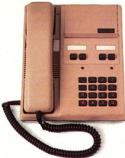
**TRITEL Arosa.** Ein Telefon mit zwei Leitungen, die gleichzeitig belegt werden können. Mit zwei Tasten zum Hin-und-her-Schalten und einer Repetiertaste für die zuletzt gewählte Nummer.
