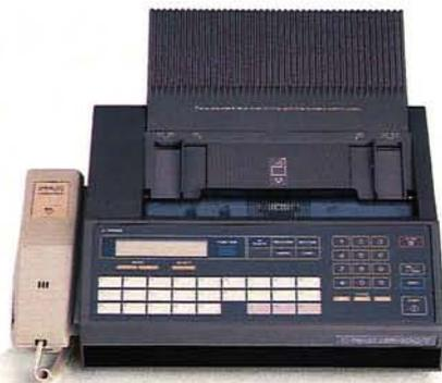
**PTT-Fax UF-100T.** Mit den gleichen Funktionen wie der UF-102T. Dazu: Speicher für 70 Telefon- oder Telefaxnummern, automatischer Dokumenteneinzug für maximal 5 Blatt. Sende- und Empfangsjournal für alle Ein- und Ausgänge. Programmierbare Sendezeit für Übermittlung zum Nachttarif. Wählbare Anfangsgeschwindigkeit für 4800 Bits pro Sekunde. Stempel zum Kennzeichnen übermittelter Seiten.
