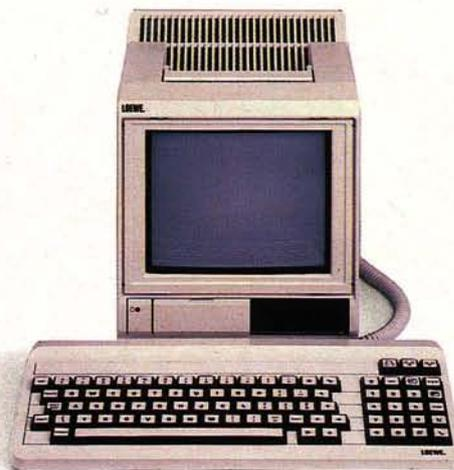
**VIDEOTEX-Datenanschlussgerät DCE 02.** Datenanschlussgerät für VIDEOTEX-Benutzer mit privaten Terminals, PCs usw., umschaltbar auf den automatischen Zugang zum schweizerischen VIDEOTEX-Dienst oder durch manuellen Verbindungsaufbau zu einer VIDEOTEX-fähigen Datenbank.
