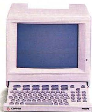
**VIDEOTEX CEPT-Tel.** VIDEOTEX-Terminal mit Schwarzweiss-Bildschirm in 9". Für Datenaustausch mit VIDEOTEX-Stationen im In- und Ausland. Eingebauter Lautsprecher zur Überwachung des Verbindungsaufbaus. Verschiedene Funktionstasten. Register für 10 VIDEOTEX-Dienste und 30 Telefon-Nummern. Integriert: VIDEOTEX-Modem für asynchrone Übertragung von 75/1200 Bits pro Sekunde und Decoder für die Darstellung von CEPT (Profil 1).
