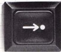
Wenn Sie die Kurzwahl benutzen möchten, heben Sie zunächst den Hörer ab, warten auf den Wählton und drücken kurz die Speichertaste. Anschließend die Zifferntaste der gewünschten Rufnummer (z. B. die 1). Jetzt wird die gespeicherte Rufnummer ausgesendet. Nach dem Gespräch legen Sie einfach auf.
