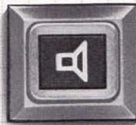
**Lautsprecher abschalten:** Falls Sie während des Gesprächs den Lautsprecher wieder ausschalten möchten, drücken Sie die innere und äußere Taste tief ein und lassen sie wieder los. Beide Tasten springen so in die Ruhelage zurück – der Lautsprecher ist ausgeschaltet. Durch Auflegen des Hörers wird die Lauthörtaste in die Ruhelage zurückgestellt – also der Lautsprecher automatisch ausgeschaltet.
